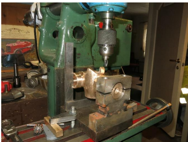
Oppspenningsfikturen til maskinering av kraner Foto: Tom Erik Hagen
