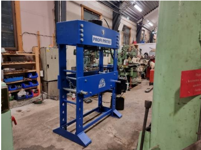
Ny hydraulisk presse på plass i verkstedet. Foto: Jørgen R. Nøkleby
