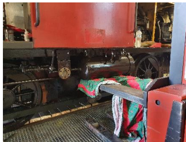
Trykklufttanken til styreventilen med holderen under montering. Foto: Jørgen R. Nøkleby
