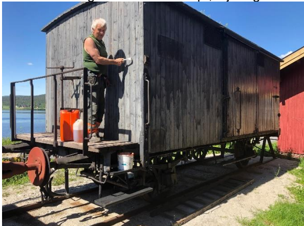
Per Kjeldaas skrapper vekk løs maling. Ommaling til rødt er tidligere blitt besluttet ettersom det ikke kan dokumenteres at vognen har vært i drift med bremsplattform, i stedet for høyt bremsarhus, og gråmalt vognkasse. Foto Henrik B. Backer
