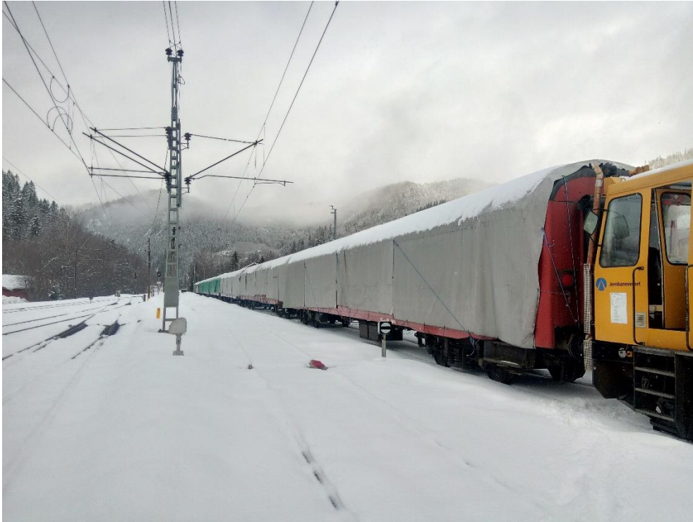
29 mars 2020. Alt av stålvogner er skiftet sammen og presenninger er sikret i helhold til forskriften. På bildet er det bremseprøve som foregår, ved hjelp av robel lånt fra Spordrift. Dette ble utført for å avdekke eventuelle feil før transporten skulle foregå.
