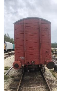
G 34207 på Kløtiefoss. Vognen er bare 2,14 m bred har påskrifter med metriske mål og fot og tommer for å kunne fremføres i Storbritannia. Foto Henrik B. Backer
