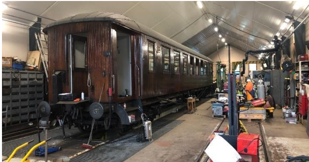
Co 220 i verkstedet i forbindelse med årskontroll. Ved kontroll av trykkluftbremsen benyttes datalogger slik at funksjon og tilstand både kan kontrolleres og dokumenteres. Foto Henrik B. Backer
