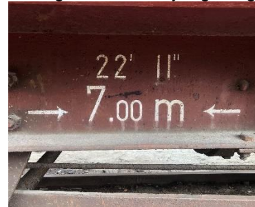
G 34207 på Kløtiefoss. Vognen er bare 2,14 m bred har påskrifter med metriske mål og fot og tommer for å kunne fremføres i Storbritannia. Foto Henrik B. Backer
