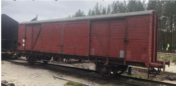
G 34207 på Kløtiefoss. Vognen er bare 2,14 m bred har påskrifter med metriske mål og fot og tommer for å kunne fremføres i Storbritannia. Foto Henrik B. Backer
