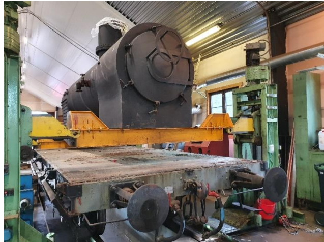
Kjelen løftes av vognen som den har stått på i ca. 20 år siden den kom fra Meiningen. Foto: Jørgen R. Nøkleby
