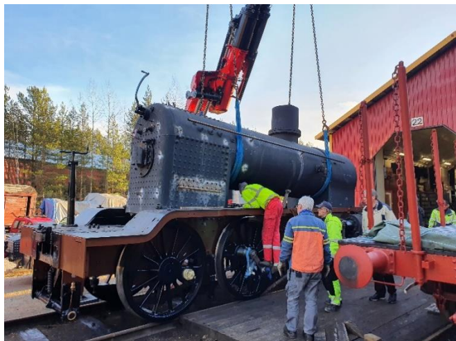
Kjelen må lirkes ned i rammen pga. Utformingen av askekassen, og klaring til geideføringer og akselkassene. Foto: Jørgen R. Nøkleby
