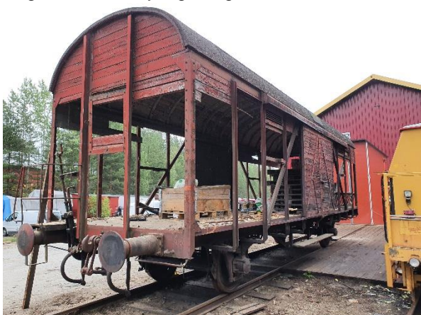
G4 41257 under riving av panel på Kløtiefoss. Foto: Jørgen R. Nøkleby
