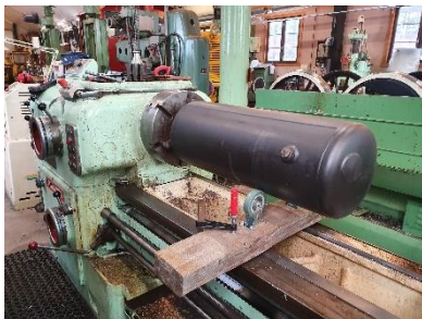
For å tromle trykkluftbeholderen til styreventilen ble det laget en egen støtte som tanken kan rulle på. Foto: Jørgen R. Nøkleby
