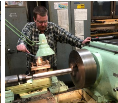
Eirik Håland dreier deler til fjæropphenget til lok 225. Foto Henrik B. Backer
