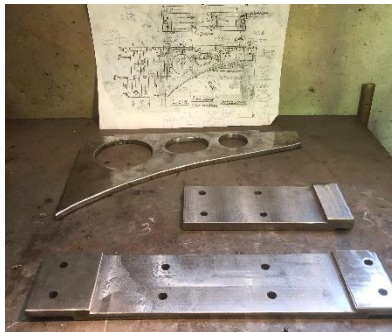
Ny konsoll til fotbrettet på høyre side ble laget ny. Her er delene ferdig maskinert. Foto Henrik B. Backer
